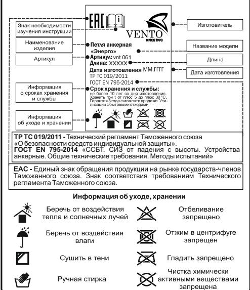
Рис. 2. Составные части и параметры
