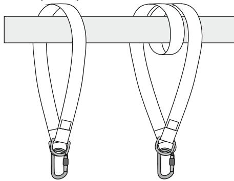
Рис. 6. Способы присоединения к иным компонентам системы
