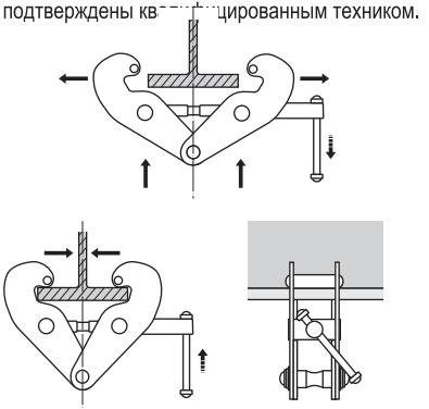
3. Замкнуть скобы зацепа на балке при помощи регулирующего винта. Скобы зацепа должны быть замкнуты на балке симметрично. Следует убедиться в том, что зацепочно прикреплен к балке и невозможно самопроизвольное отсоединение зацепа.
