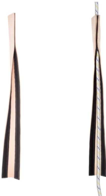
TU 322 – защитный рукав, изготовленный из натуральной кожи и застегивающийся на липучку, предназначен для рабочего троса блокирующего устройства, отвечающего норме EN 353-2 (LINOSTOP II, ACO10). TU 322 предотвращает истирание троса.
