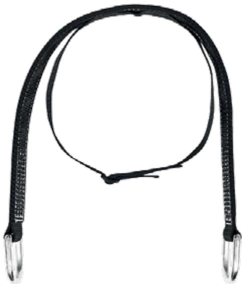
Арбористический ремень предназначен для эластичных стяжек, улучшающих статику дерева. Ремень не препятствует увеличению толщины ствола и не травмирует дерево. Ремень изготовлен из полиэстеровой ленты шириной 45 мм и оснащен коваными стальными пряжками типа D ринг. Оборудован лентой для крепления на стволе.
