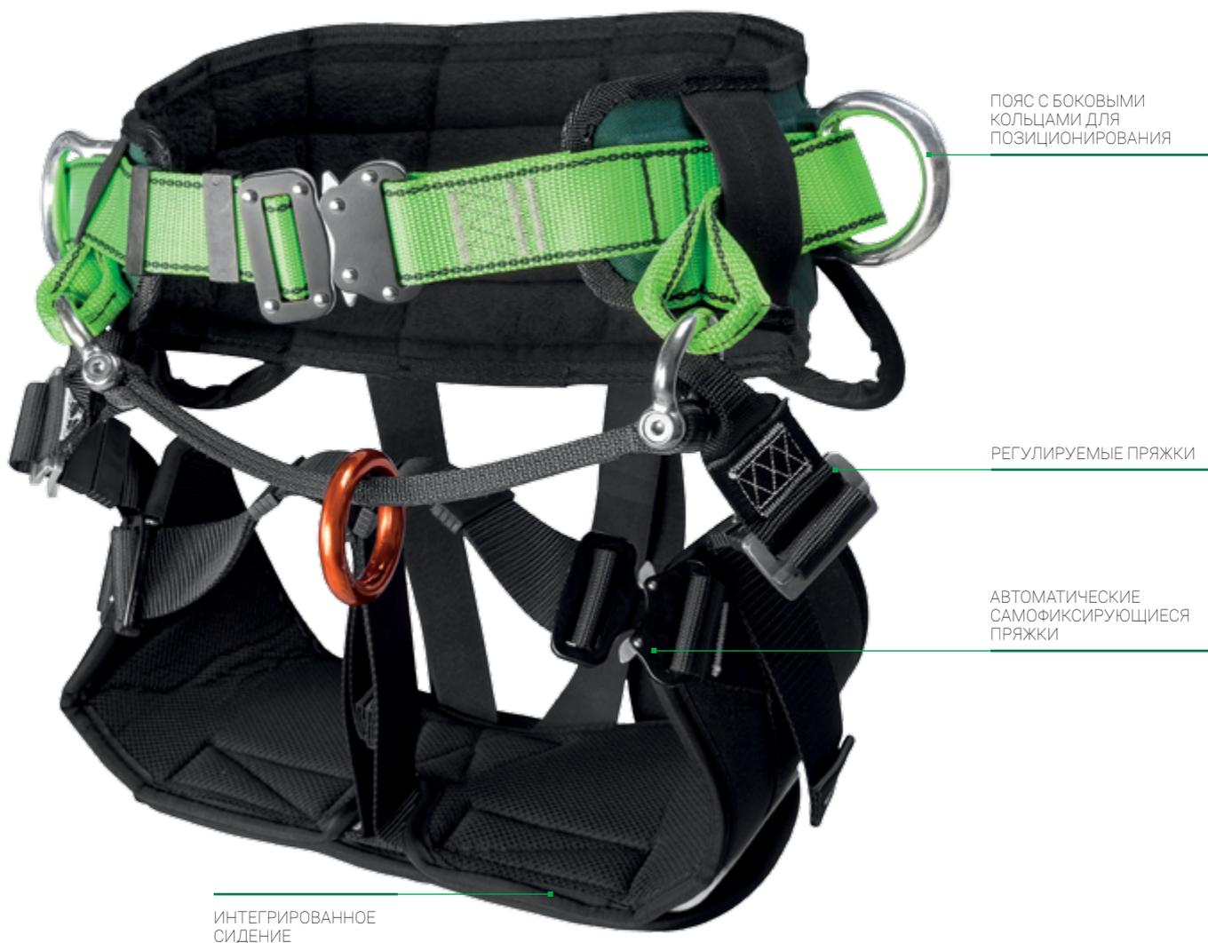
TH 050 это пояс для работы в подпоре с интегрированным сидением. Оборудован соответствующе профилированным сидением, регулирующими пряжками, боковыми кольцами и точкой крепления для принятия положения «сидя» согласно норме EN 813:2008. Пояс оснащен автоматическими самофиксирующимися пряжками. TH 050 удобен в надевании и снятии.
