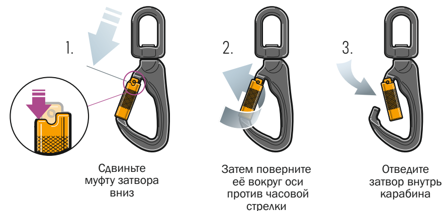
Рис. 3 Принцип работы карабина класса Т.
