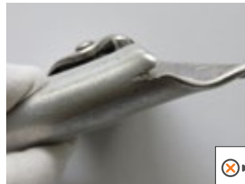
• Трещины на корпусе
