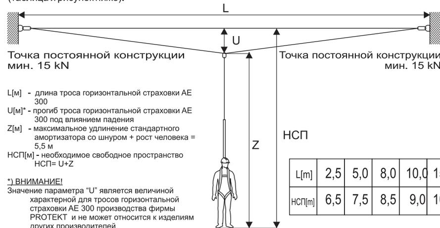
Точка постоянной конструкции мин. 15 kN
