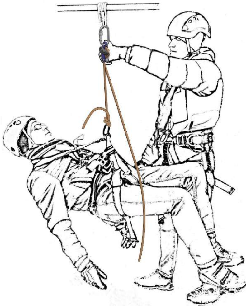
Рисунок 8. Спуск пострадавшего. Устройство закреплено на анкерной точке
