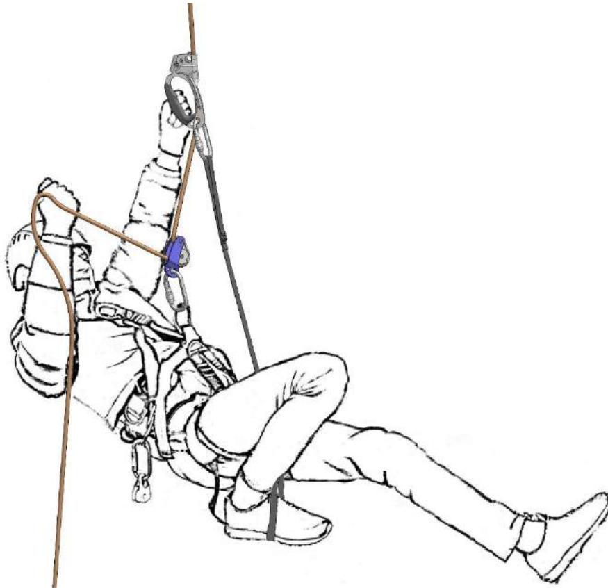
Рисунок 4. Подъём по верёвке с помощью жумара и петли для ног
