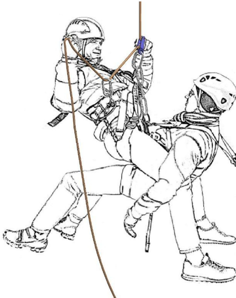
Рисунок 7. Спуск с пострадавшим. Устройство закреплено на привязи
