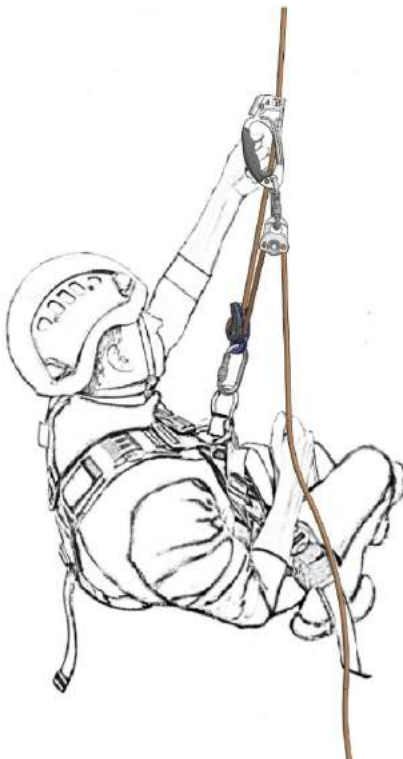
Рисунок 5. Подъём по верёвке с помощью жумара, петли для ног и блок-ролика
