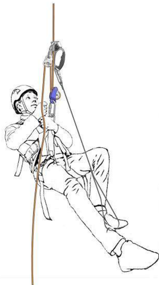
Рисунок 6. Подъём по верёвке с помощью жумара и блок-ролика
